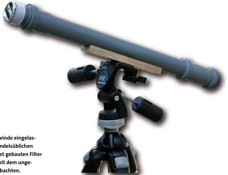
In die Unterseite der Holzschiene ist ein Stativgewinde eingelassen, so dass das Baumarkt-Teleskop auf jedem handelsüblichen Fotostativ befestigt werden kann. Mit einem selbst gebauten Filter aus Sonnenschutzfolie ausgestattet, lassen sich mit dem ungewöhnlichen Instrument sogar Sonnenflecken beobachten.
