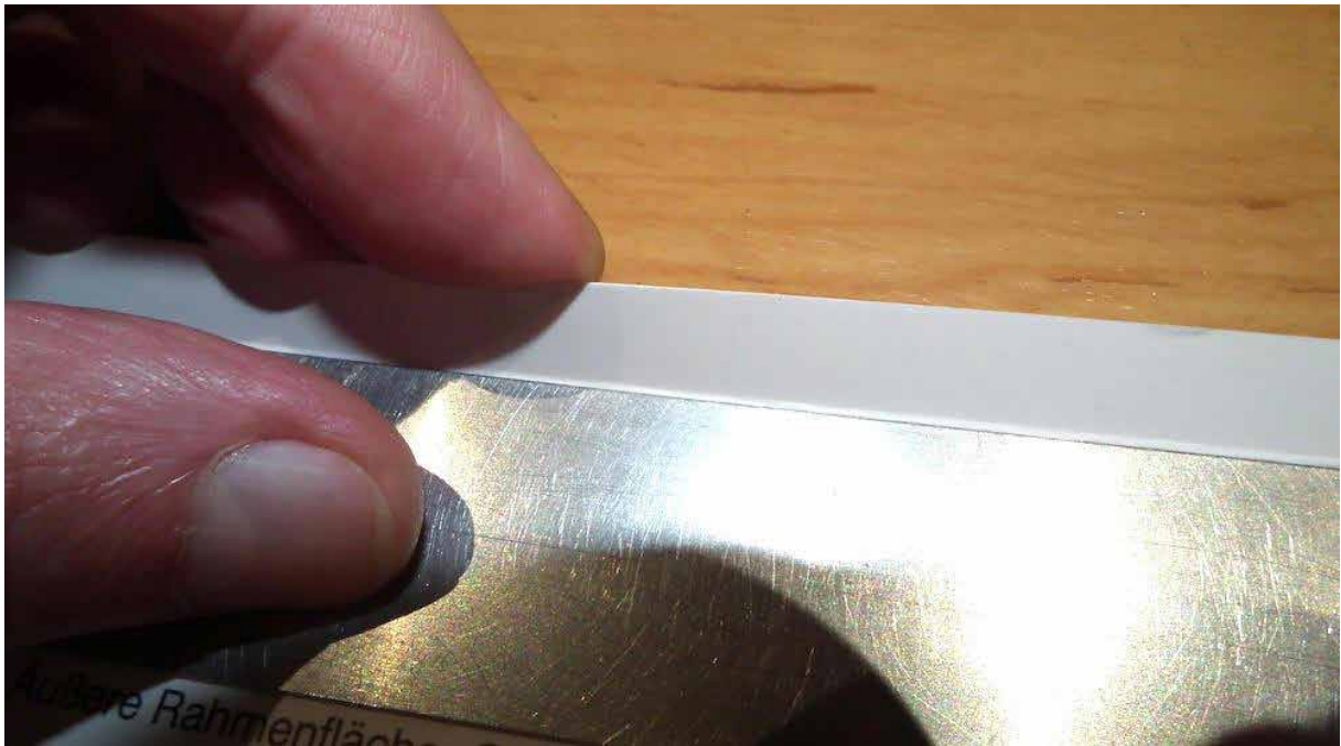
Plegado de las piezas del marco con ayuda de una regla de acero.
