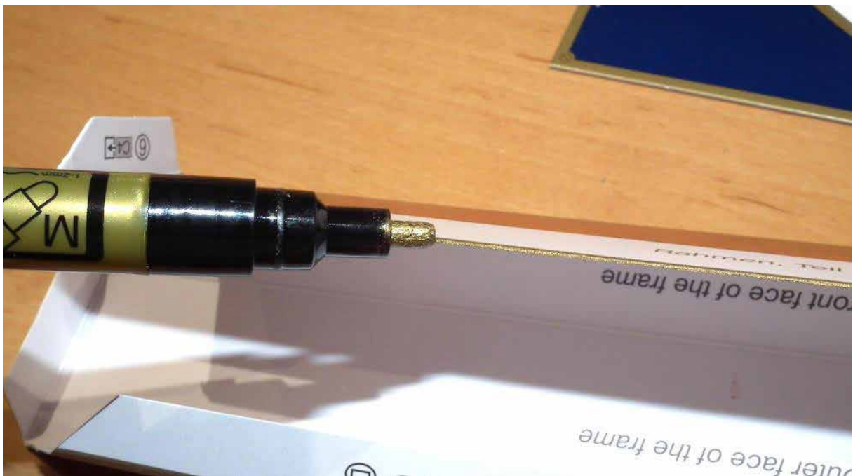
Pintura en dorado de los bordes abiertos de las piezas del marco.
