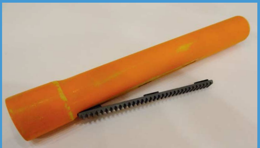
Ein verkürztes Elektro-Stangenrohr wird das neue Okularzugrohr
