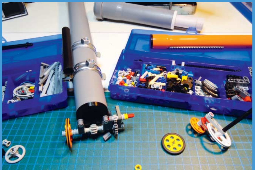
Der Zahnstangenauszug wird mit Lego-Technic-Bauteilen umgesetzt.
