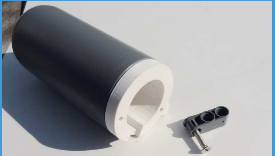
Der neue Okularführungskern aus dem 3D-Drucker im Haupttubus
