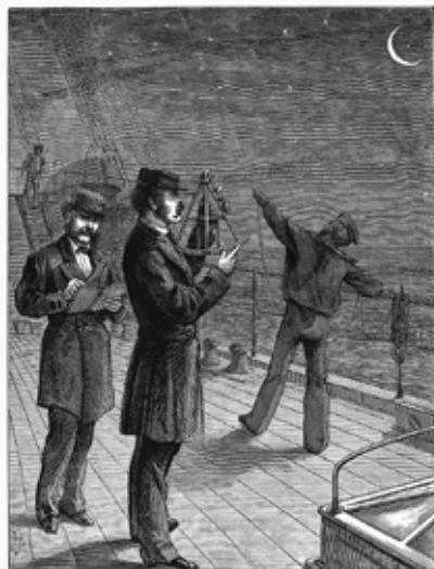
Ein Navigator misst den Winkelabstand zwischen dem Mond und einem Stern.
